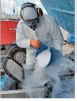
A Les pellets sont ensuite déposés dans la trémie d'un nettoyeur cryogénique, qui va réguler l'alimentation en glace de la buse de tir, ainsi que la pression d'air fournie par le compresseur.
