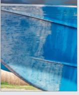
🗖 L'effet nettoyant est l'aboutissement de trois actions conjuguées : l'impact mécanique de la glace dure sur la peinture, la création de microfissures dans le matériau grâce au froid intense et l'effet de souffle local provoqué par
