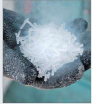
2 Ces petits blocs de glace carbonique (ici des sticks de 16 mm) sont au cœur du décapage cryogénique. La température très basse (– 79 °C) et la dureté mécanique de la carboglace associent leurs effets de choc, thermique et mécanique, pour décoller les couches de peinture accumulée.
